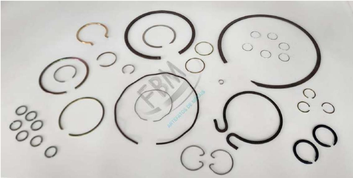
O Anel Trava também é conhecido como anel elástico, anel de retenção ou anel de segurança e sua função é de impedir o deslocamento de eixos de um sistema, ele limita o deslocamento de componentes, define o posicionamento de outras peças e pode até posicionar corretamente outros componentes. O diferencial deste tipo de modelo é que os anéis travas possuem uma abertura.
